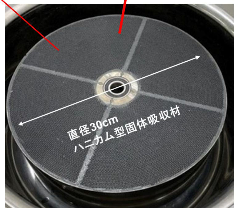
空気再生型ハニカムロータリー式DAC基礎実験機
