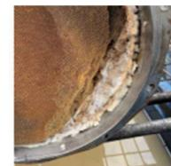
・異常が発生したSCR触媒の実物写真
