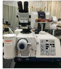
断面作製装置 (Hitachi IM4000plus) 2020年度導入
