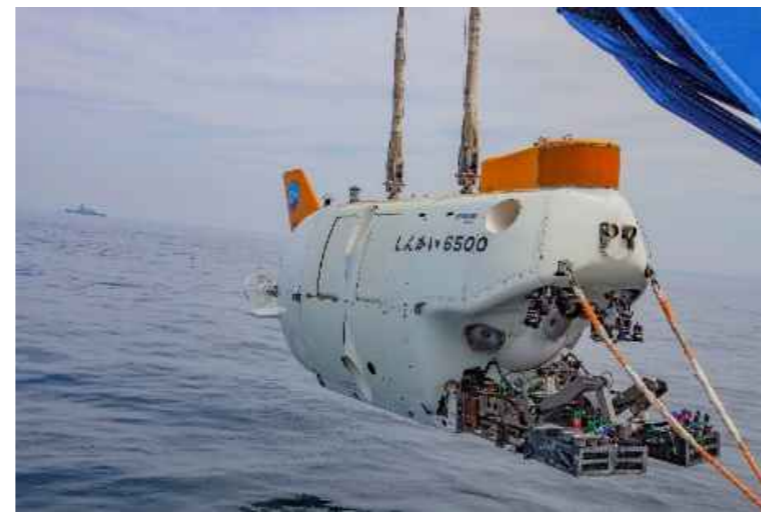
潜水船による設置・回収作業
