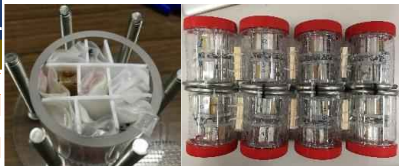
生分解性プラスチックを入れたチャンバー
