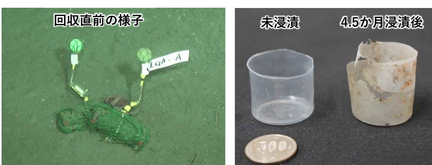
上: 4か月半の深海設置実験後の分解の様子。 右: 本事業で開発し、現場生分解性を実証した素材の成果を報告したニュースサイト。
