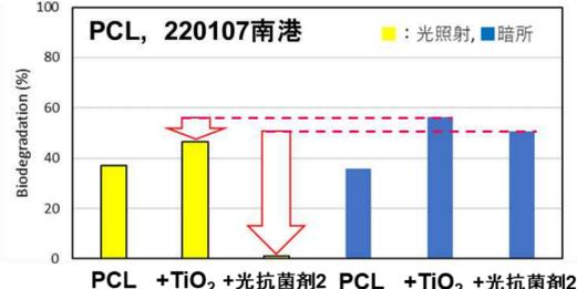
蛍光灯連続照射下での未処理天然海水中でのBOD生分解試験において、OFF型樹脂では4週間後の生分解率が大きく抑制された。
