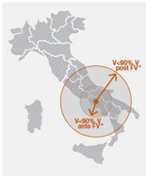
図 48 回転型発電機をインバータに置き換えることで短絡電流が減少し、電圧の擾乱のエリアが拡大する
