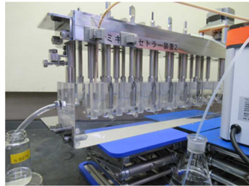
図 4.3.1-38 ミキサセトラ抽出装置の外観
