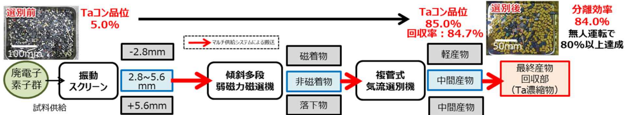
図 4.2-28 マルチ供給制御システムの自動搬送試験(電子素子群からのタンタルコンデンサ回収例)
