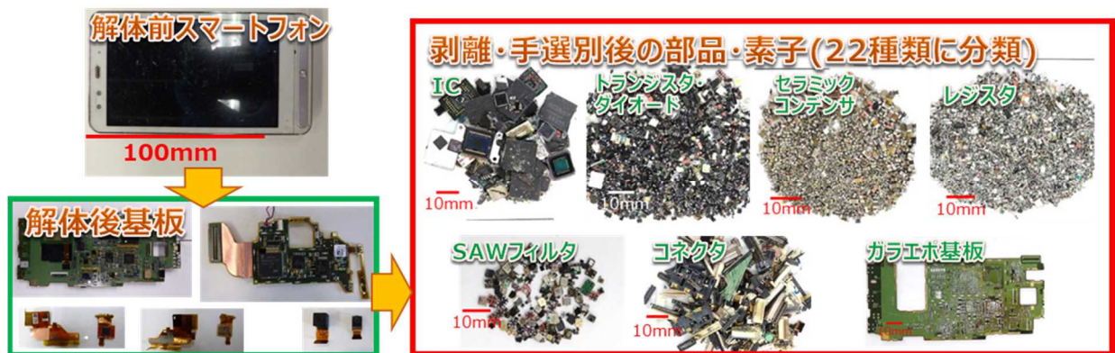
図 4.2-8 スマートフォンの電子素子調査の例
