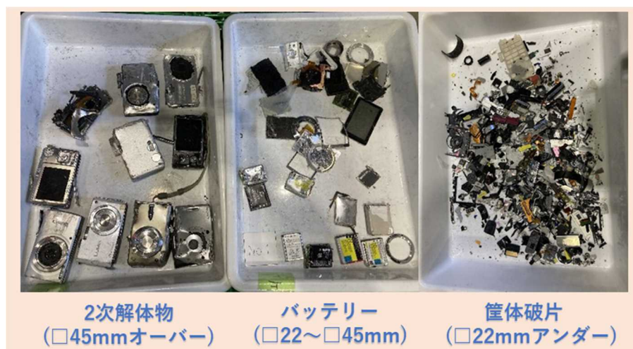
図 4.1-18 2 段振動篩によるデジカメ選別結果の例
