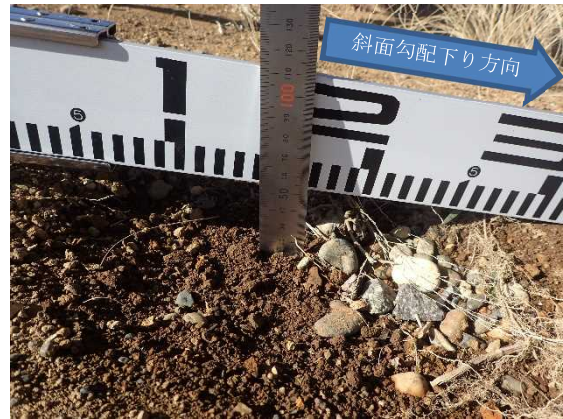
図 5-3 15 度裸地 雨だれ集中位置（左：落下位置拡大、右：侵食深さ）
