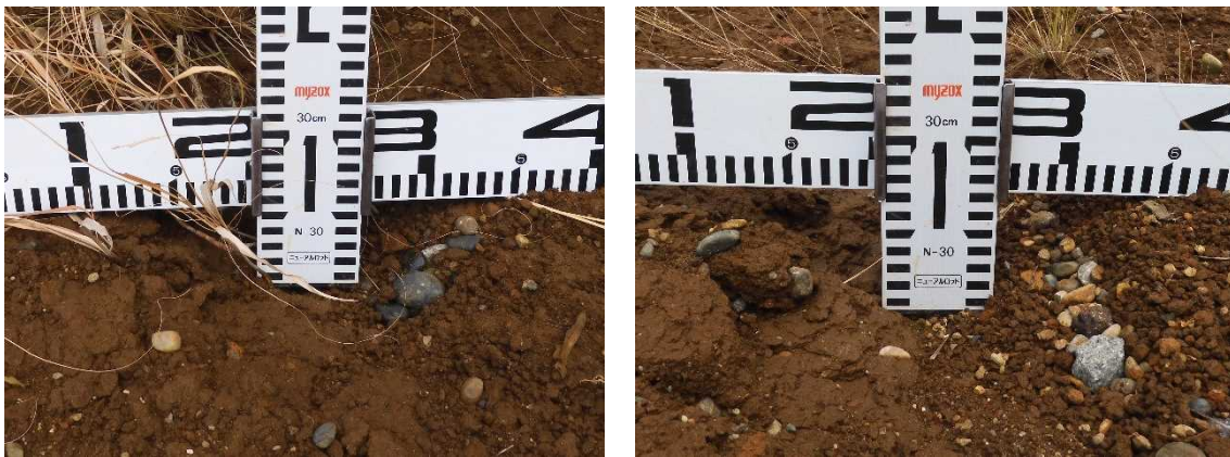
図 5-8 [約 2 年経過時点] 30 度裸地 雨だれ位置の最大侵食深さ : 70mm (左 : 中間、右 : 水下側)
