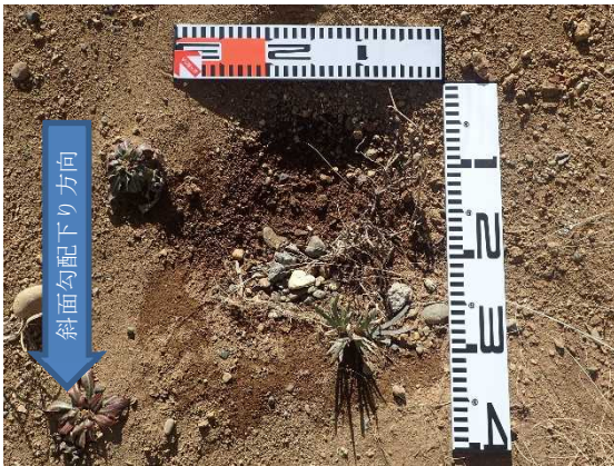
図 5-3 15 度裸地 雨だれ集中位置（左：落下位置拡大、右：侵食深さ）
