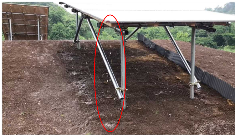
図 4-5 降雨時模擬 PV (傾斜 15 度_裸地)
