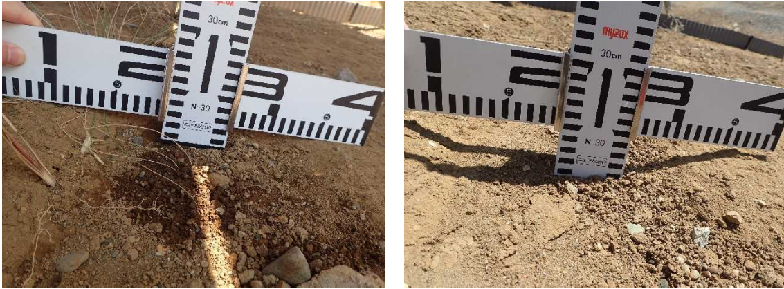
図 5-7 [約 1 年経過時点] 30 度裸地 雨だれ位置の最大侵食深さ : 40mm (左 : 中間、右 : 水下側)
