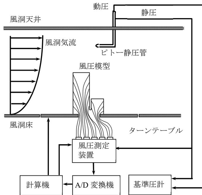
図 5-4 風洞ならびに風圧測定システム
