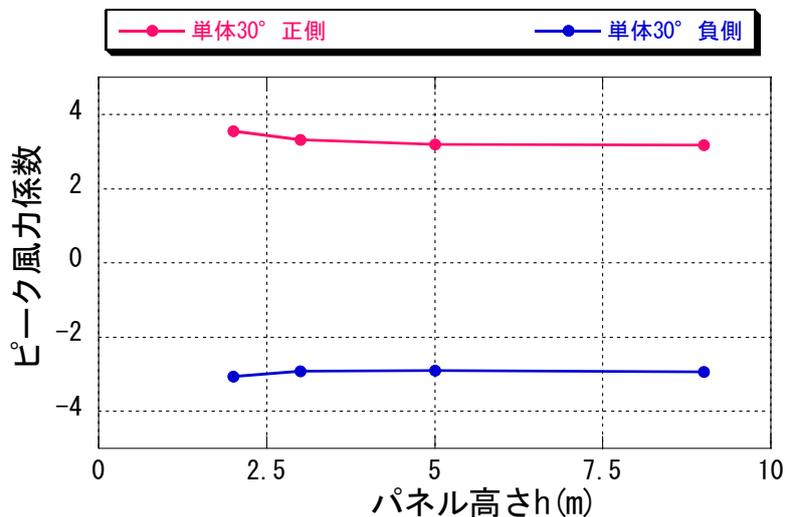
図 6-3 単体パネルの面平均最大・最小ピーク風力係数
