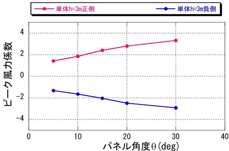
図 6-2 単体パネルの面平均最大・最小ピーク風力係数
