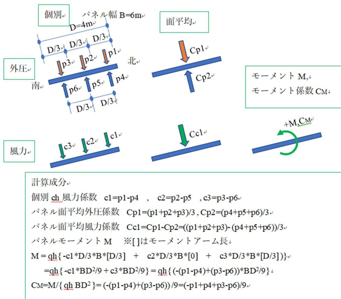
図 3-3 風圧計測 ch と風力等計算点の概要
