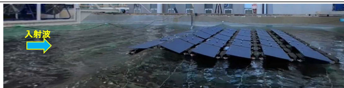
図 5-14 (4/5) 最高波作用状況 (ケース名 : FL_IW08-10) 動画内時間 : 235. 8s
