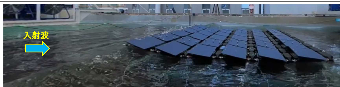
図 5-14 (3/5) 最高波作用状況 (ケース名 : FL_IW08-10) 動画内時間 : 235. 6s
