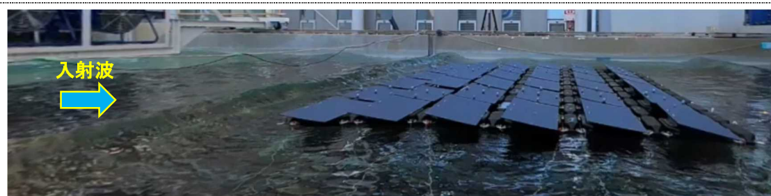
図 5-14 (1/5) 最高波作用状況 (ケース名 : FL_IW08-10) 動画内時間 : 235. 2s
