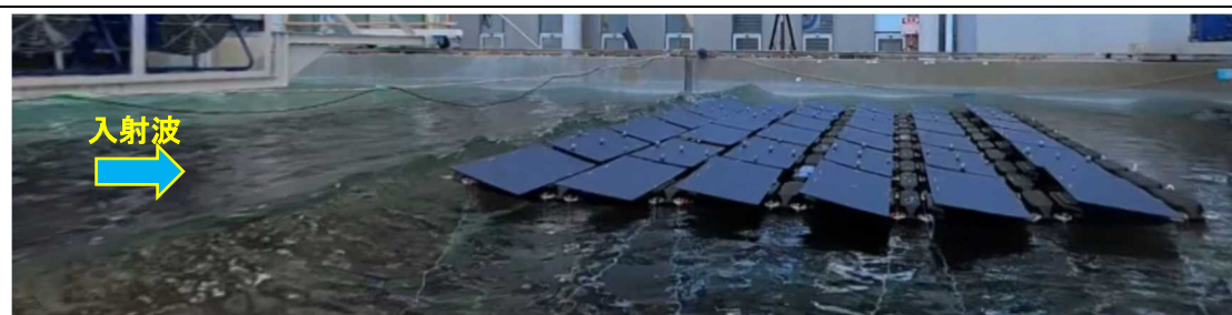
図 5-14 (2/5) 最高波作用状況 (ケース名 : FL_IW08-10) 動画内時間 : 235. 4s
