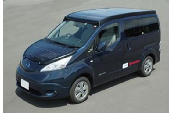
図 1.2-2 太陽光発電システム搭載自動車実証車両 (2) : eNV200 (日産自動車株) 25
