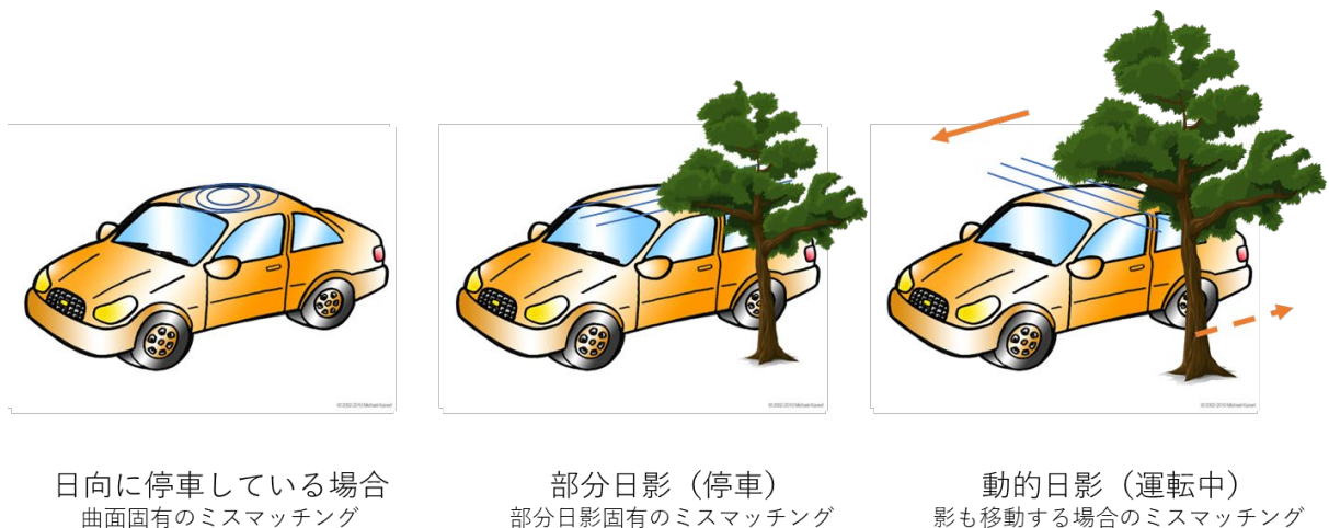
図 3.1-1 曲面、部分日影、動的日影が出力低下に与える影響の概念図
