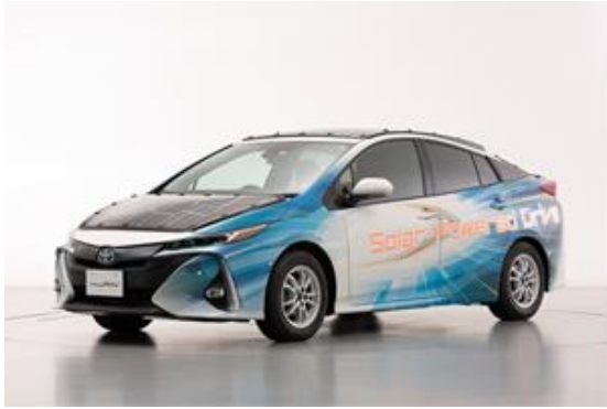
図 1.2-1 太陽光発電システム搭載自動車実証車両 (1) : プリウスプラグインハイブリッド (トヨタ自動車株) 24
