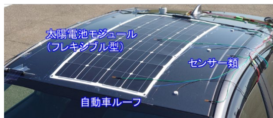
図 3.3-4 自動車ルーフに貼り付けた太陽電池モジュール 19
