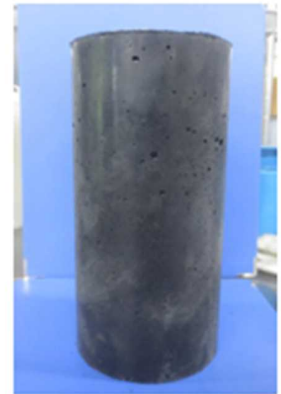
コンクリート供試体
