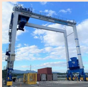
FCパワーパックラバータイヤ式門型クレーン（RTGC） 出典：三井E&S 及び NEDOによる2023/4/18 ニュースリリース
