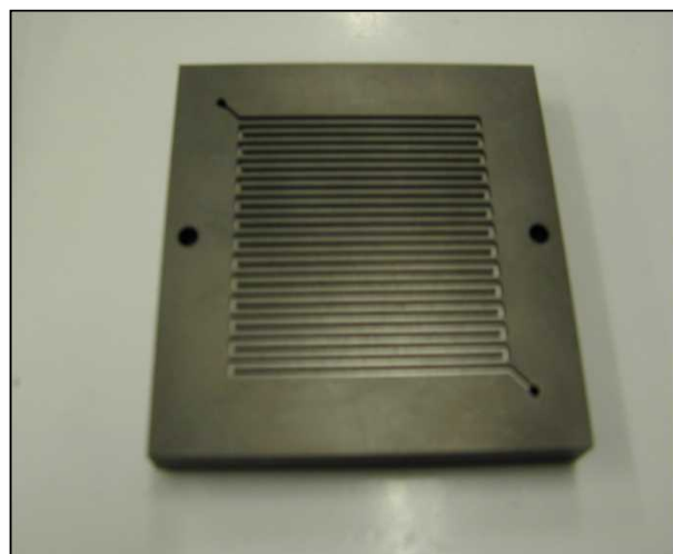
JARI標準セルのガス流路
