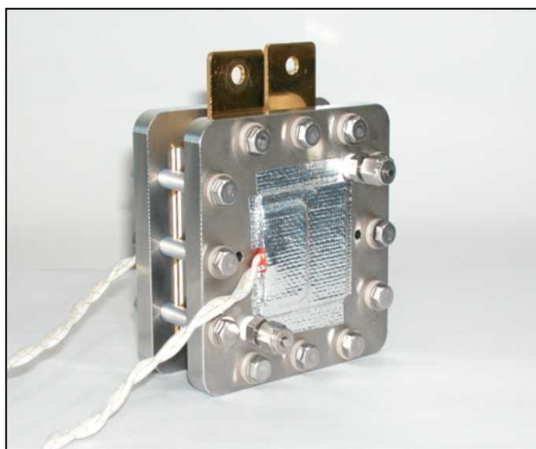
JARI標準セルの組付け状態
