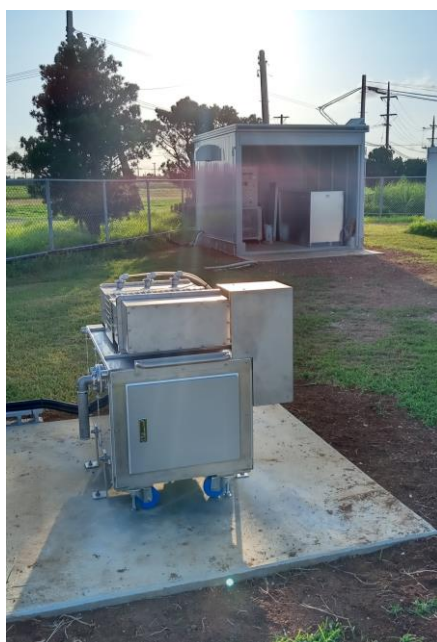
図 3-2.2.14-4 塩害地における腐食疲労試験機の外観写真
