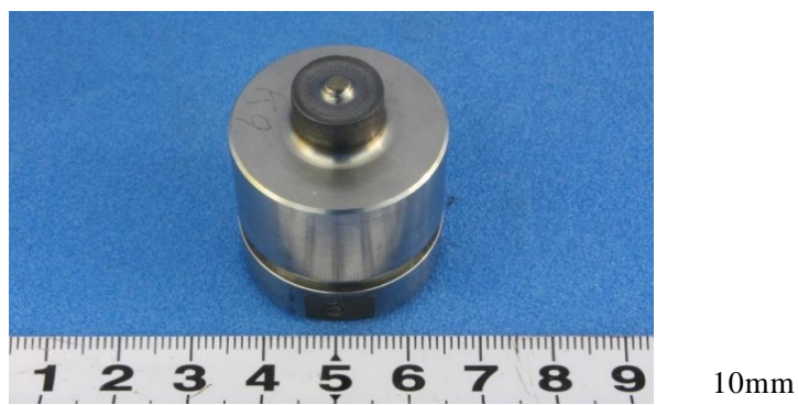
図 3-2.2.8.B-29 370MPa 級 SPHC 鋼板を FSW 接合した後の Co 合金ツールの外観
