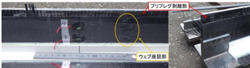
図 3-2.2.7-9 試験後の構造破壊状況
