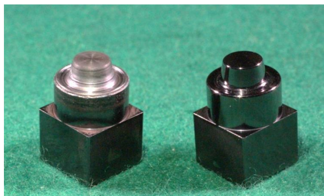
図 3-2.2.6-7 ツール写真（左：1万打点後、右：新品）
