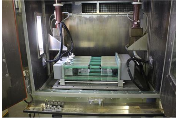
図 3-2.2.14-1 複合サイクル腐食試験装置内に設置された腐食疲労試験機本体
