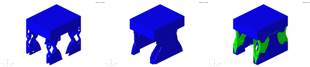
図 3-2.1.1-9 マルチ材料 3次元固有振動数最大化問題の数値計算例(左：一材料、一次固有振動モード、中：一材料、一～三次固有振動モード、右：三材料、一～三次固有振動モード)
