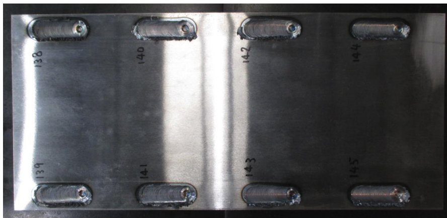
図 3-2.2.8.B-14 2020 年度作製プレス成形部材(ハット材)接合サンプル品
