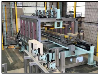
(c) 養生装置
