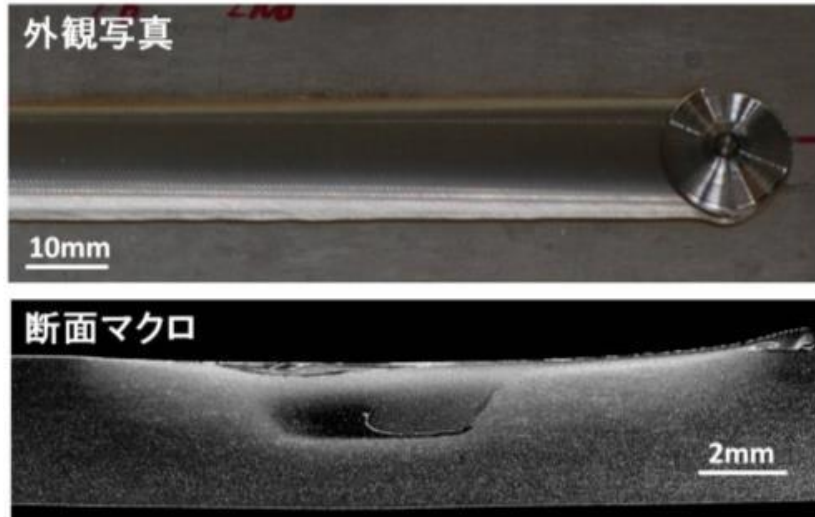
図 3-2.2.8.A-28 Ti-6Al-4V 合金 FSW 部の外観写真と断面マクロ
