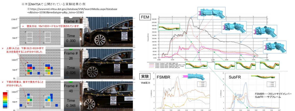
図 3-2.1.1-44 前突における壁反力と主要断面力の履歴
