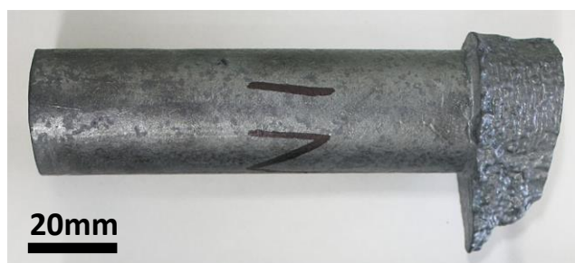
図 3-2.2.8.A-23 試作した Co 基合金インゴット
