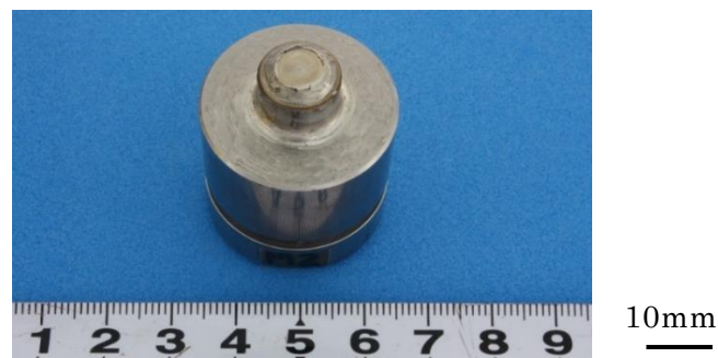
図 3-2.2.8.B-33 SUS304 鋼板を FSW 接合した後のツールの外観
