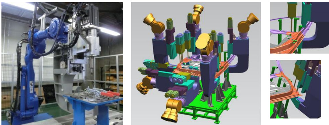
図 3-2.2.5-29 ドアインナーへの FSSW 接合ロボットのアクセス性検討 3-2.2.5-19
