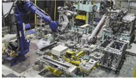
図 3-2.2.7-22 鋼 CFRP 複合部材の連続製造図の一例
