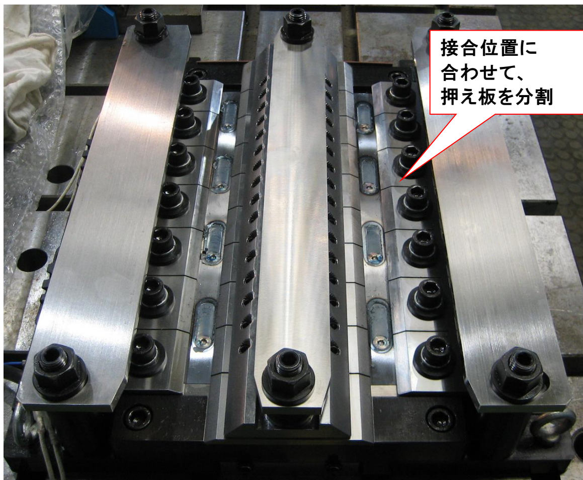
図 3-2.2.8.B-16 プレス成形部材(ハット材)用クランプ治具改良品
