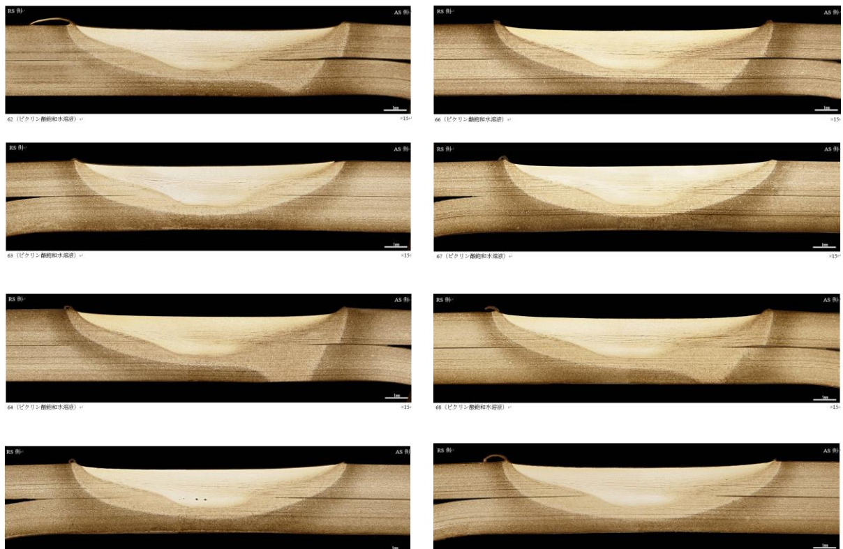
図 3-2.2.8.B-18 プレス成形部材(ハット材)接合部断面マクロ写真 (クランプ治具改良前)
