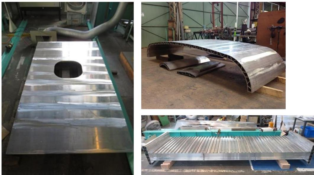
図 3-2.5.2-16 接合後の簡易モックアップ構体の外観
