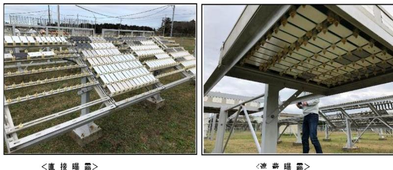
図 3-2.5.5-4 直接暴露と遮蔽暴露
