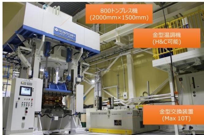
図 3-2.7.1.2-16 800 トンプレス機システムの構築
