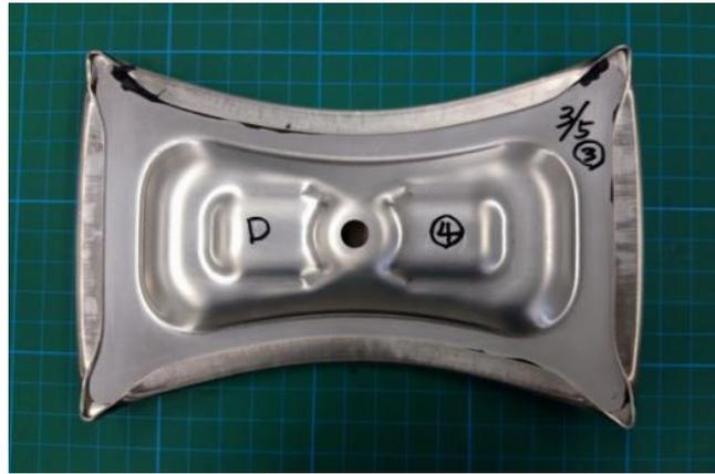
図 3-2.5.7.132 小型フード(インナ/アウト、ヘム)形状の成形テスト (インナ・アウト成形品のヘム加工成形体外観)
