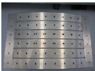
図 3-2.5.7-9 AXM4102 の長尺 MIG 溶接外観
