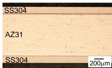
図 3-2.6.4-4 鋼/Mg 合金の複層化
