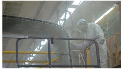
図 3-2.5.5-9 モデル構体への化成処理と塗装
