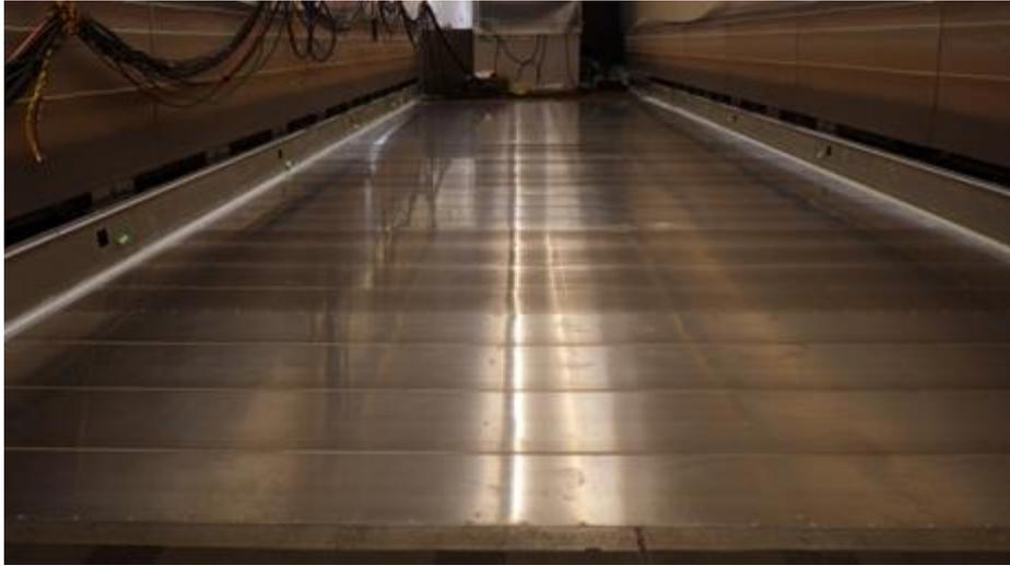
図 3-2.5.7-38 実車両に適用された難燃性 Mg 合金製客室床
