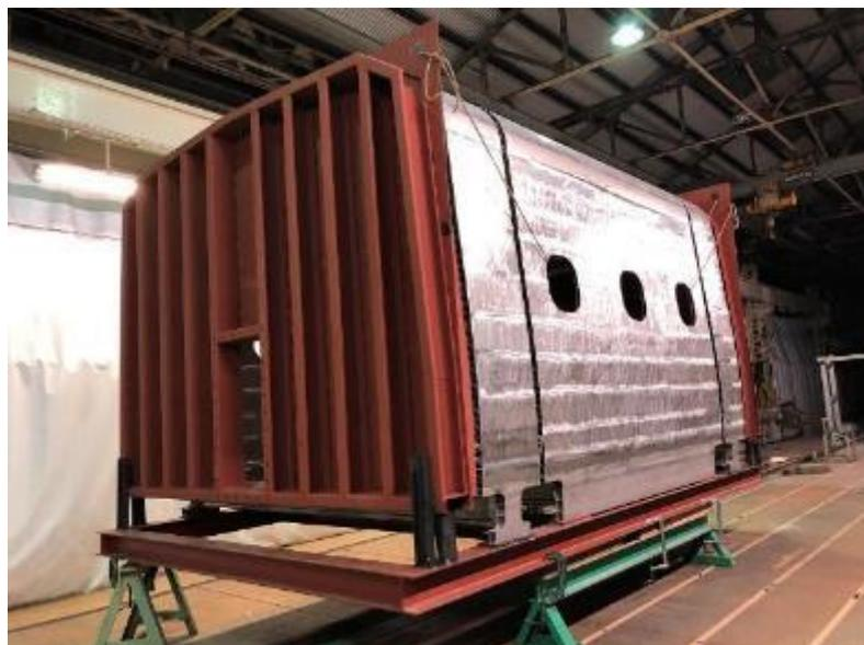
図 3-2.5.7-6 気密疲労試験用 6 面体構体
