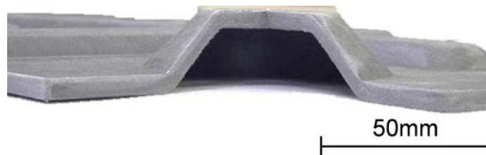
図 3-2.7.3.2-10 熱可塑性 CFRP フォームのプレス成形品の例
