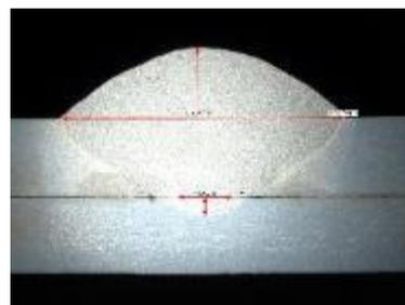
図 3-2.5.7-10 AXM4102 の長尺 MIG 溶接断面マクロ写真
