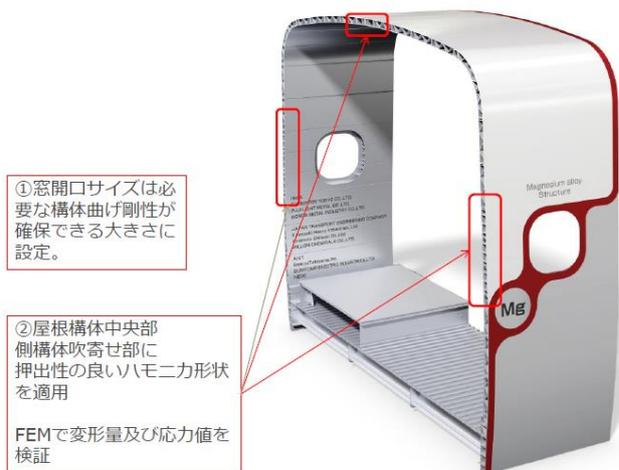
図 3-2.5.1-19 簡易モックアップの構造的特徴
