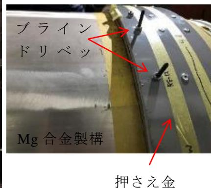
図 3-2.5.7-7 構体接続部の拡大図
