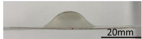
図 3-2.5.7-129 室温エリクセン試験結果
