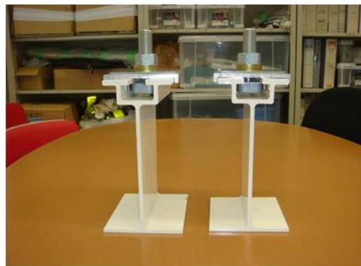
図 3-2.5.1-20 床下機器吊供試体
