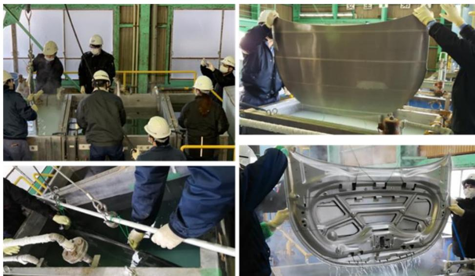
図 3-2.5.7-66 1/1 フロントフード処理の様子
