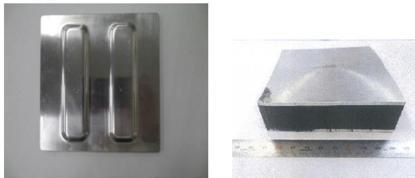
図 3-2.7.4-17 アルミ／CFRTP 一体成形品
