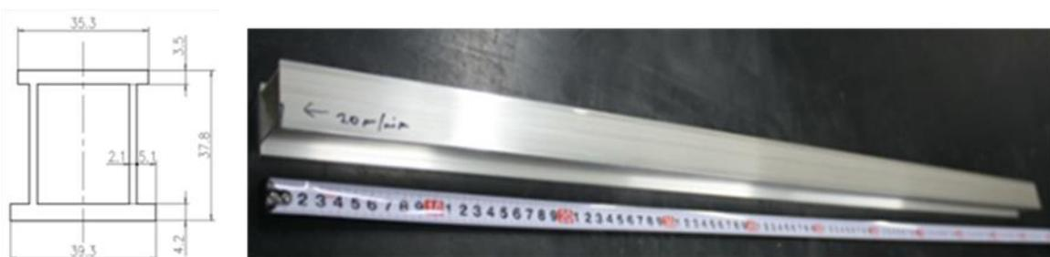
図 3-2.5.7-90 試作した AXM10207 合金ドアビーム型材
