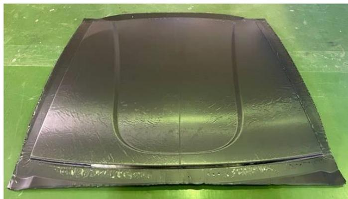
図 3-2.7.3.2-51 端部を CFRP にて拘束した成形品
