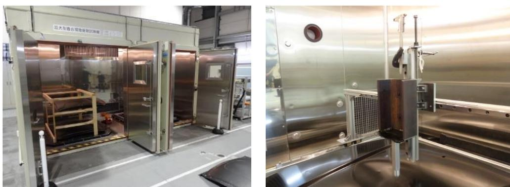
図 3-2.7.3.2-56 評価設備（左：環境試験室、右：押込治具）
