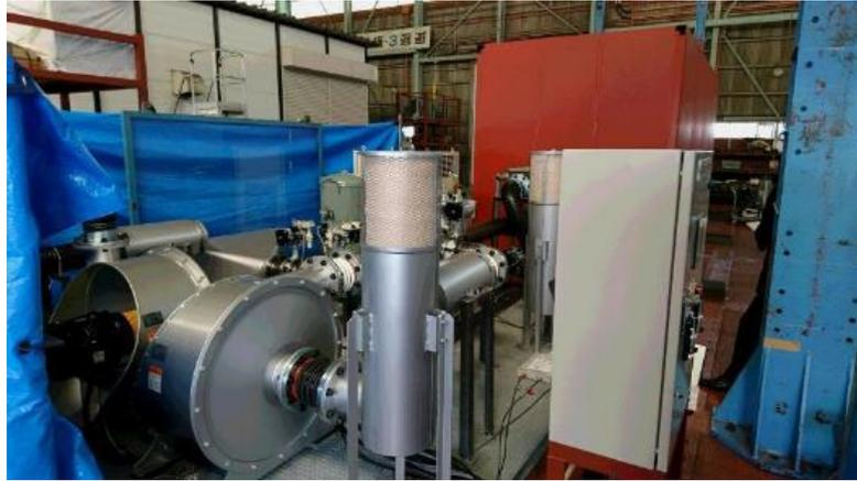
図 3-2.5.7-19 模擬構体による気密荷重試験
