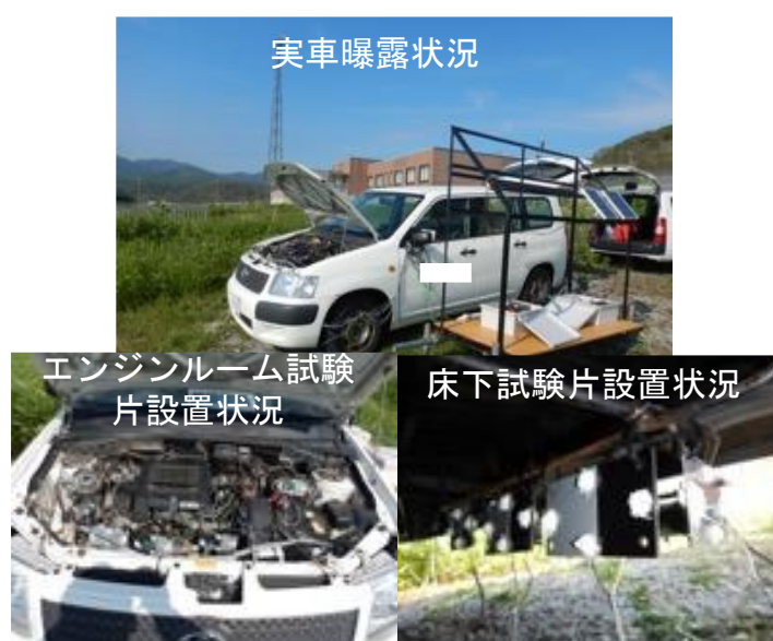
図 3-2.9.7-14 実車曝露試験の様子
