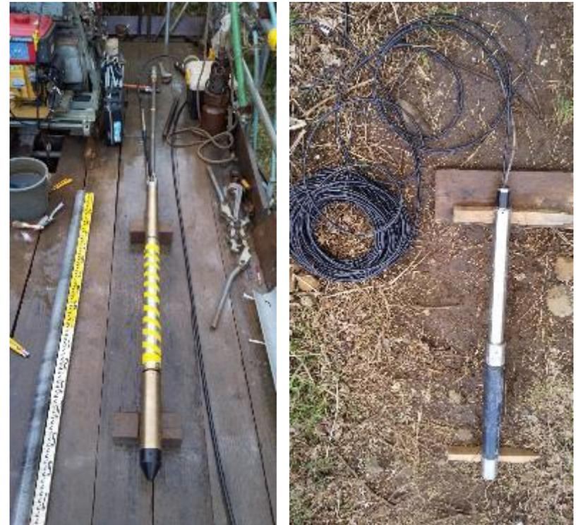
図\_HP D(左)とエラストメーター(右)の写真
