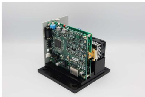
図 6 モジュール光源 駆動回路の試作
