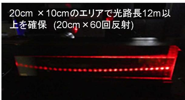
図14 開発したガスアンテナ
