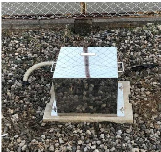
写真 3.2-1 地盤に設置した地震計
