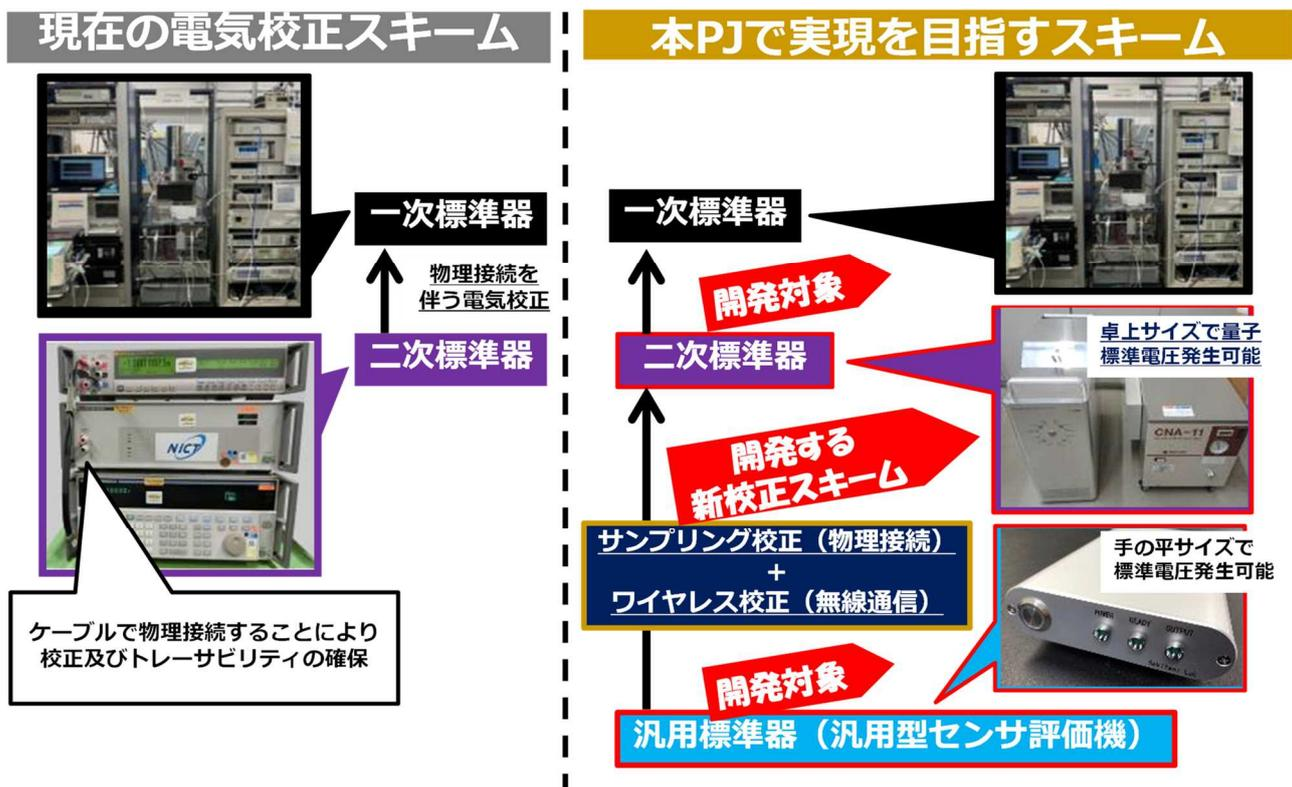
図 1 現在の電気校正スキームと本研究で開発する新しい校正スキームの違い
