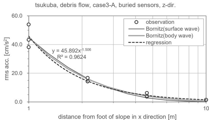
図 3.2-18 rms 振幅の距離減衰特性 (z 方向)
