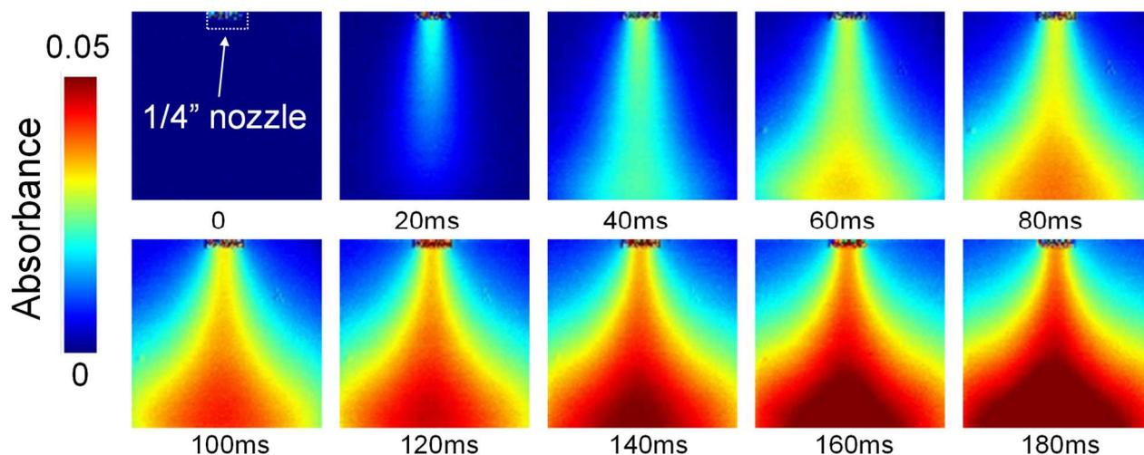
図 4. 1/4 インチ配管ノズルから 133Pa の真空チャンバー内に噴き出す NO<sub>2</sub> ガス濃度分布の可視化結果。1000 枚／秒で 100%Ar から 100%NO<sub>2</sub> へのガス切り替え時を撮像。ガスがノズルから吹出ステージ上で水平方向に広がる様子が明瞭に撮像出来ている。画像から濃度分布の移動速度は 7.4mm/ms であると抽出出来た。
