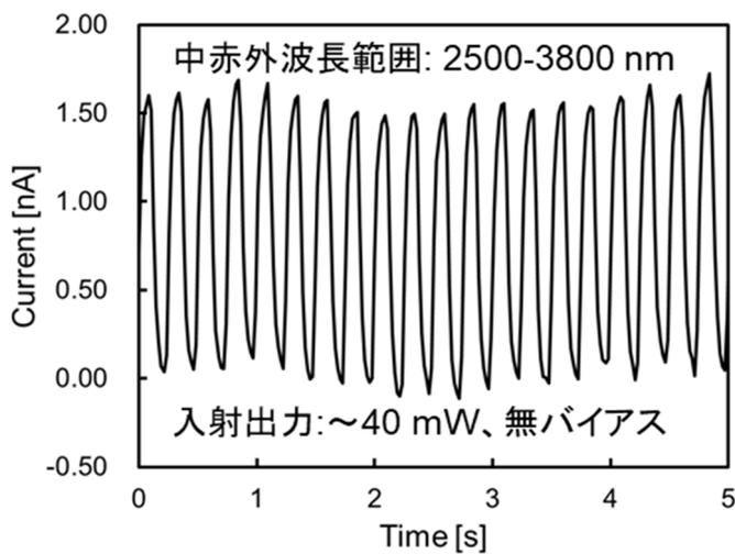
図②-(2)-4 試作中赤外ディテクタの光応答
