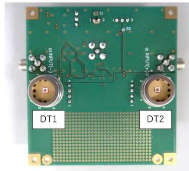
図 10 試作した差動検出受光モジュール
