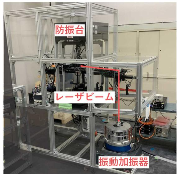
図 3.2.7.2.④-3 鉛直振動測定装置の概観
