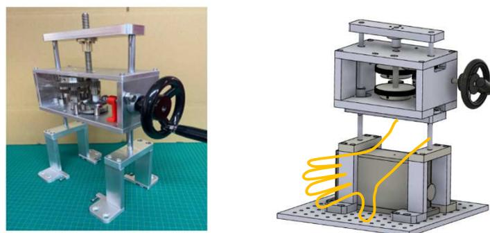
図①-4 押し圧調整治具
