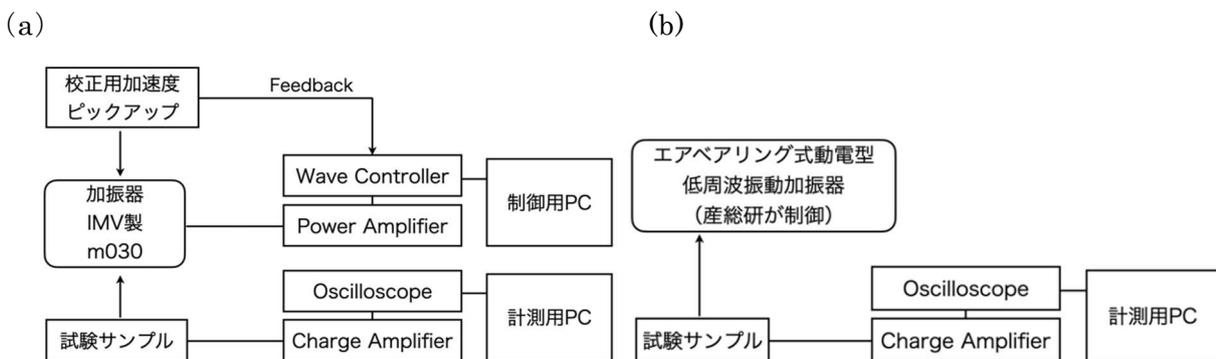
図 3.2-4 (a) 研究室における振動計測環境。加振周波数 5 Hz 以上にて試験を行った。(b) 産業技術総合研究所における試験環境。加振周波数 0.1 Hz から試験を行った。
