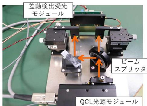
図 11 差動検出動作確認用の光学系
