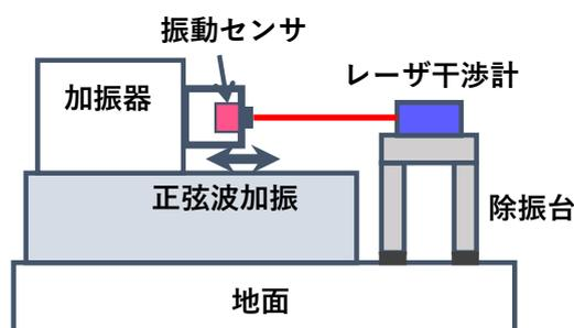
図 3.2.7.2.④-1 振動測定装置の模式図
