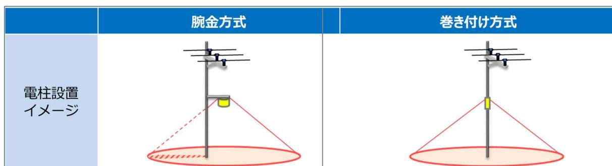
図 3.2-22 シート型マルチセンサ設置方式の方向性
