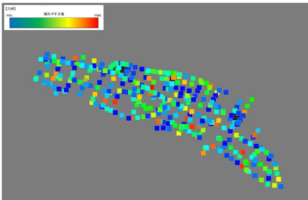
図 3.2-20 模擬地震による低層住宅全壊率予測値の空間分布図例
