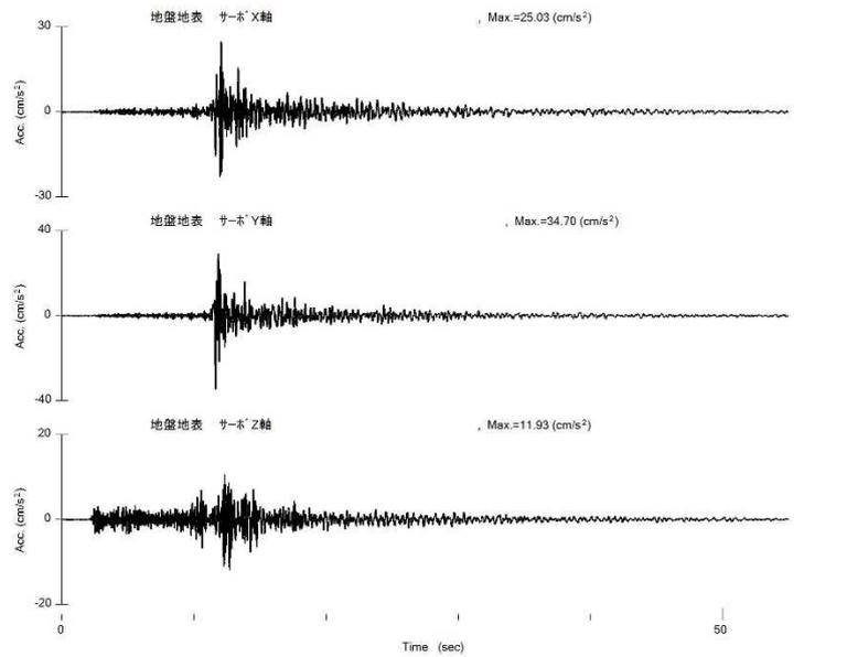
図 3.2-12 地盤で計測した地震記録の時刻歴
