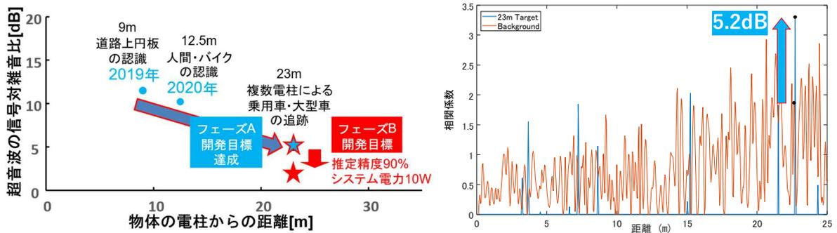
図 3.2-8 左：電柱からの距離と信号対雑音比、右：23mにおいて5.2dBを達成
