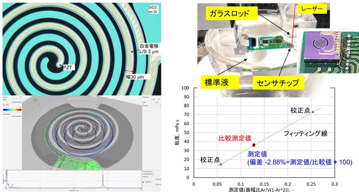
図 3.2.3 試作した MEMS 粘性センサと低ノイズ化センサヘッド基板に実装して標準液により標準液中で評価している状況
