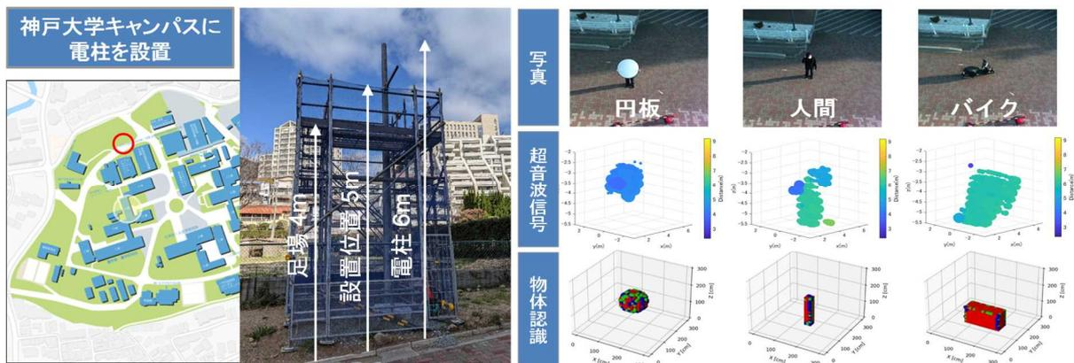
図 3.2-10 左：神戸大学キャンパス内に設置した電柱、右：円板・人間・バイクの推論例
