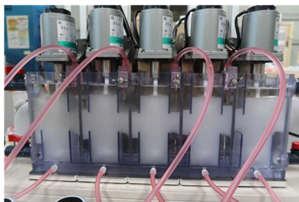
図 3-11 Ce/La 分離での機械攪拌式 EF 装置システム
