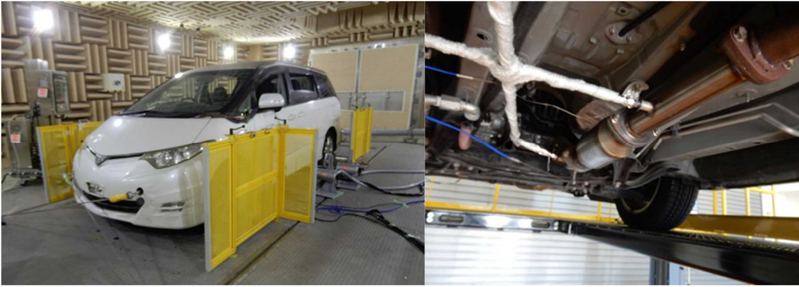
写真 3-1 シャシーダイナモ上の車両と排気系に装着されたハニカム触媒
