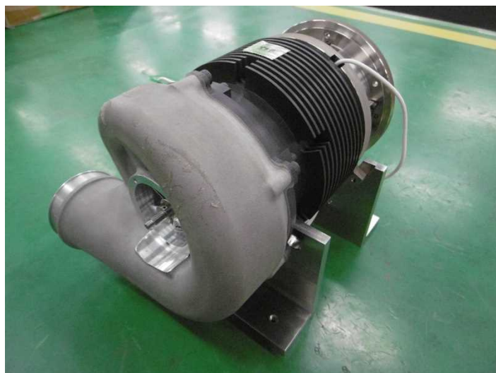
図 B-2-3-1 作製した評価試験モーターシステムの外観写真
