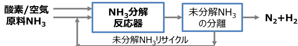
オートサーマル式アンモニア分解プロセス概略フロー図
