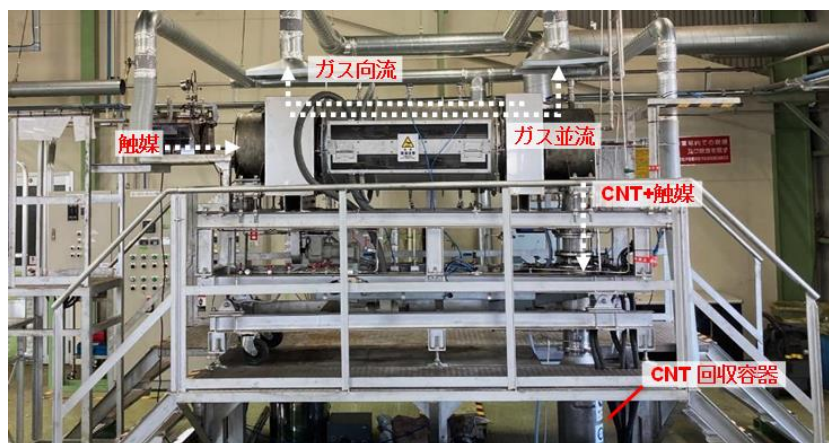
図 2 パイロット連続式ロータリーキルン本体（炉心寸法 250φ×2000mm）
