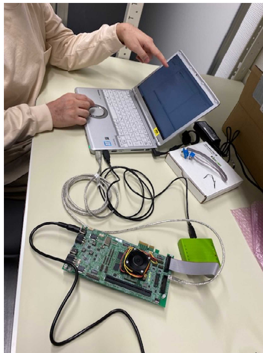
図 3-22 評価ボードとデバッガによる動作検証の様子
