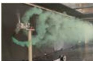
図2 浮体式風車ウエイク現象の可視化
