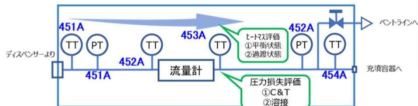
ヒートマス及び圧力損失の影響評価装置
