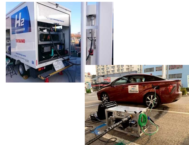
水素燃料システム計量精度検査の実施
