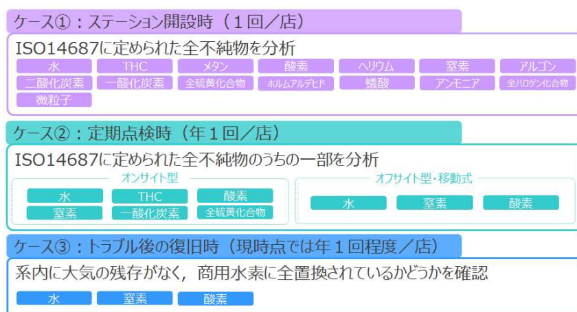
図3 実運用における水素品質管理に係る純度分析のパターン
