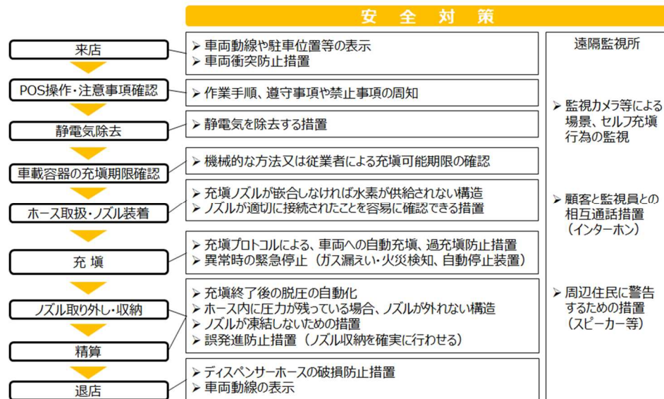
図3 顧客によるセルフ充填を可能にするための安全対策
