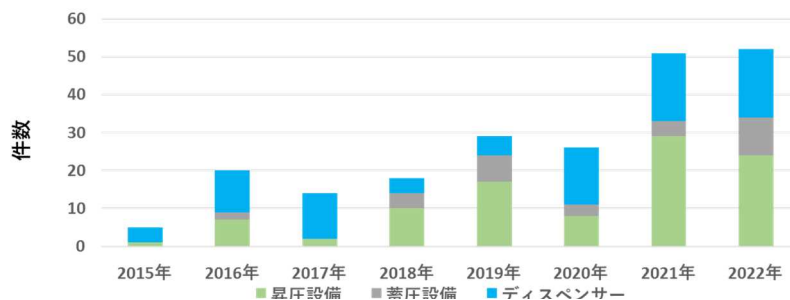
図7 外部漏洩発生設備の推移
