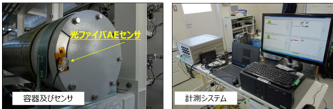
図18 実機蓄圧器の光ファイバAE センサ装着状況及びAE 信号計測状況
