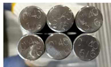
図 4 作製した冷間引抜材の外観 (冷間加工度 40%、 \phi 20 、酸洗浄済)
