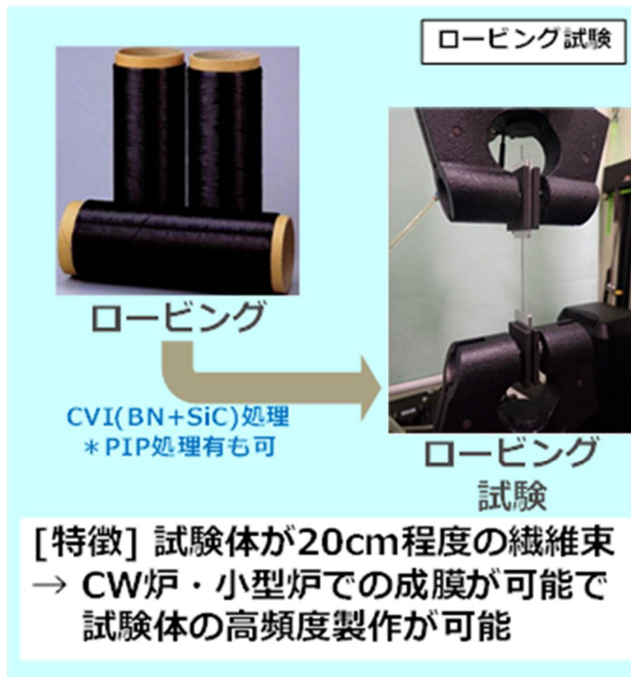
図④-(1)-1 ロービング試験概要と試験の様子
