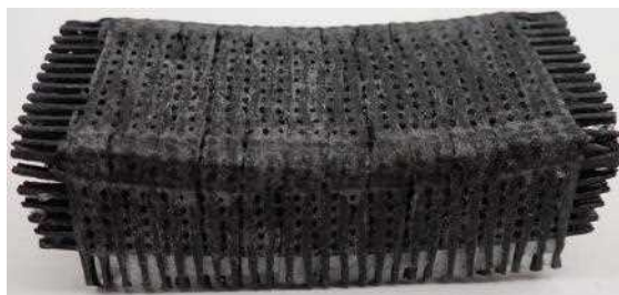
図4-3 繊維状態によらないニアネットシェイプでの三次元プリフォーム試作品
