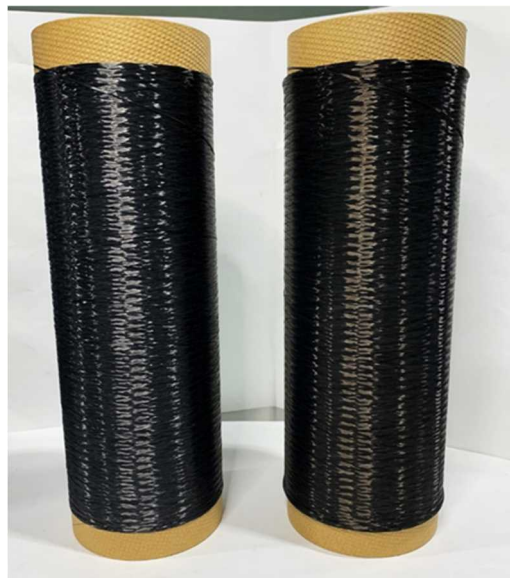
図3. 本研究開発で試作した超高性能 SiC 繊維 (右側) * 左は通常の耐熱性チラノ繊維
