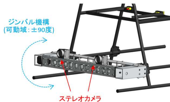
図 2.2.2.1-26 カメラジンバル CAD 図とその可動範囲
