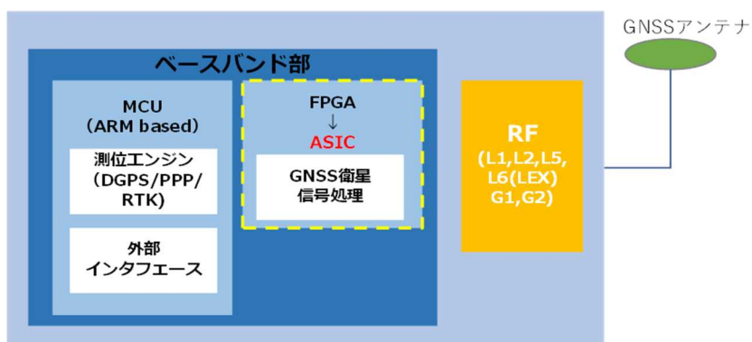
図 2.2.2.5-1 デジタルベースバンド部の ASIC 化
