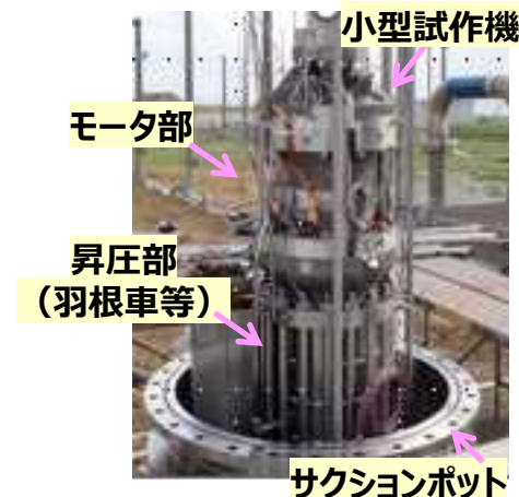
Fig. 据付中の小型試作機
