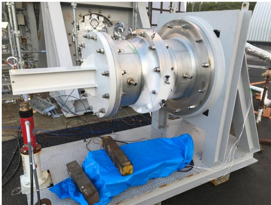
図 2-1 大口径船陸継手 液化水素実液試験状況
