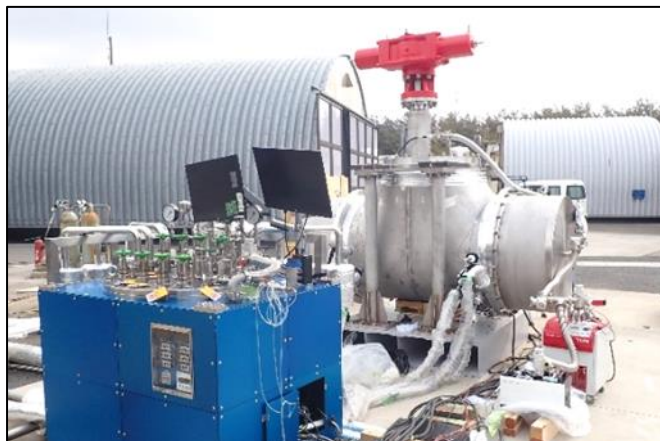
図 5. 大型試作品による LH 2 実液試験の様子
