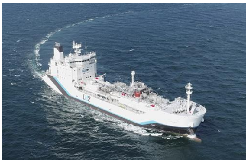
図 16 液化水素運搬船 海上公試の様子
