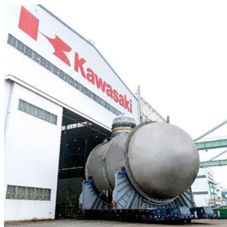
図 13 内筒・外筒一体化後のタンクシステムの様子
