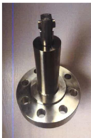
図 13 ガスブラスト方式ノズル部の外観写真
