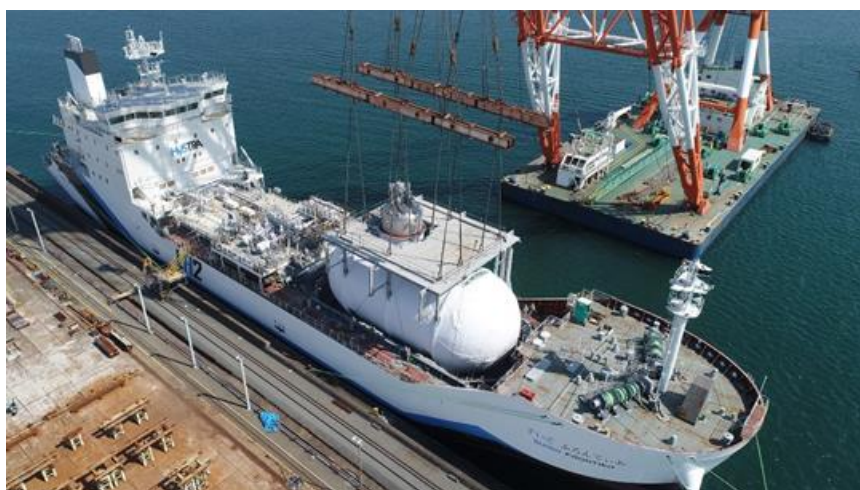
図 15 船体への本タンクシステム搭載作業時の様子
