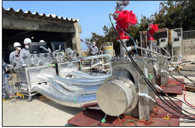
図 3. 実機試作品による LH 2 実液試験の様子
