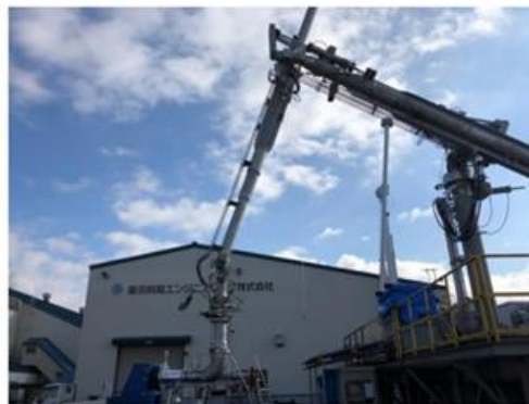
図 38 鋼管型ローディングアーム(メーカー工場)
