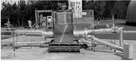
図 11 10B ボール弁 JAXA 試験の様子
