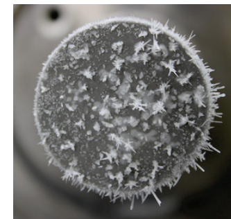
昇華による回収実験後の冷却フランジ部の様子
