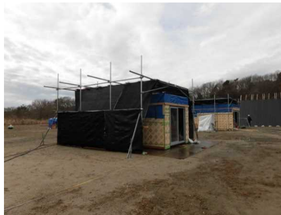
エアコン・ショーケース フィジカルハザード用模擬室(R290)
