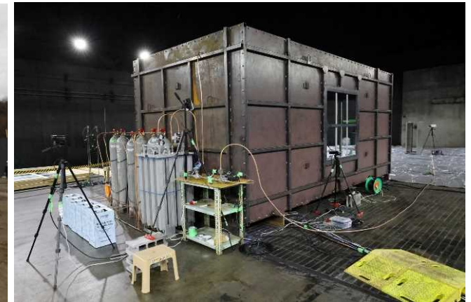
エアコンR32・R1234yf用模擬室
