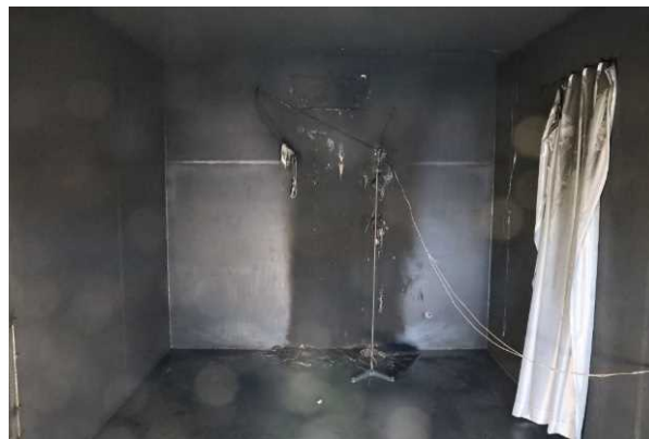
放出中の着火によって焼失した室内機 (現在の最大許容充填量)
