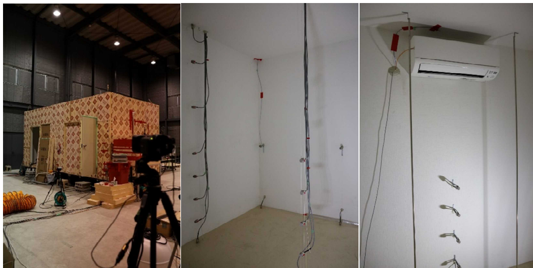
模擬室内に設置された 室内機とプロパン濃度センサー
