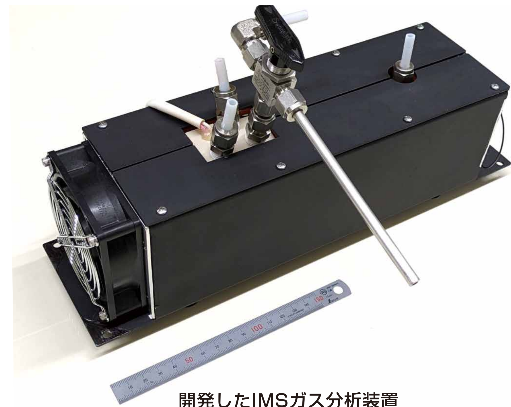
開発したIMSガス分析装置 IMS gas analyzer prototype
