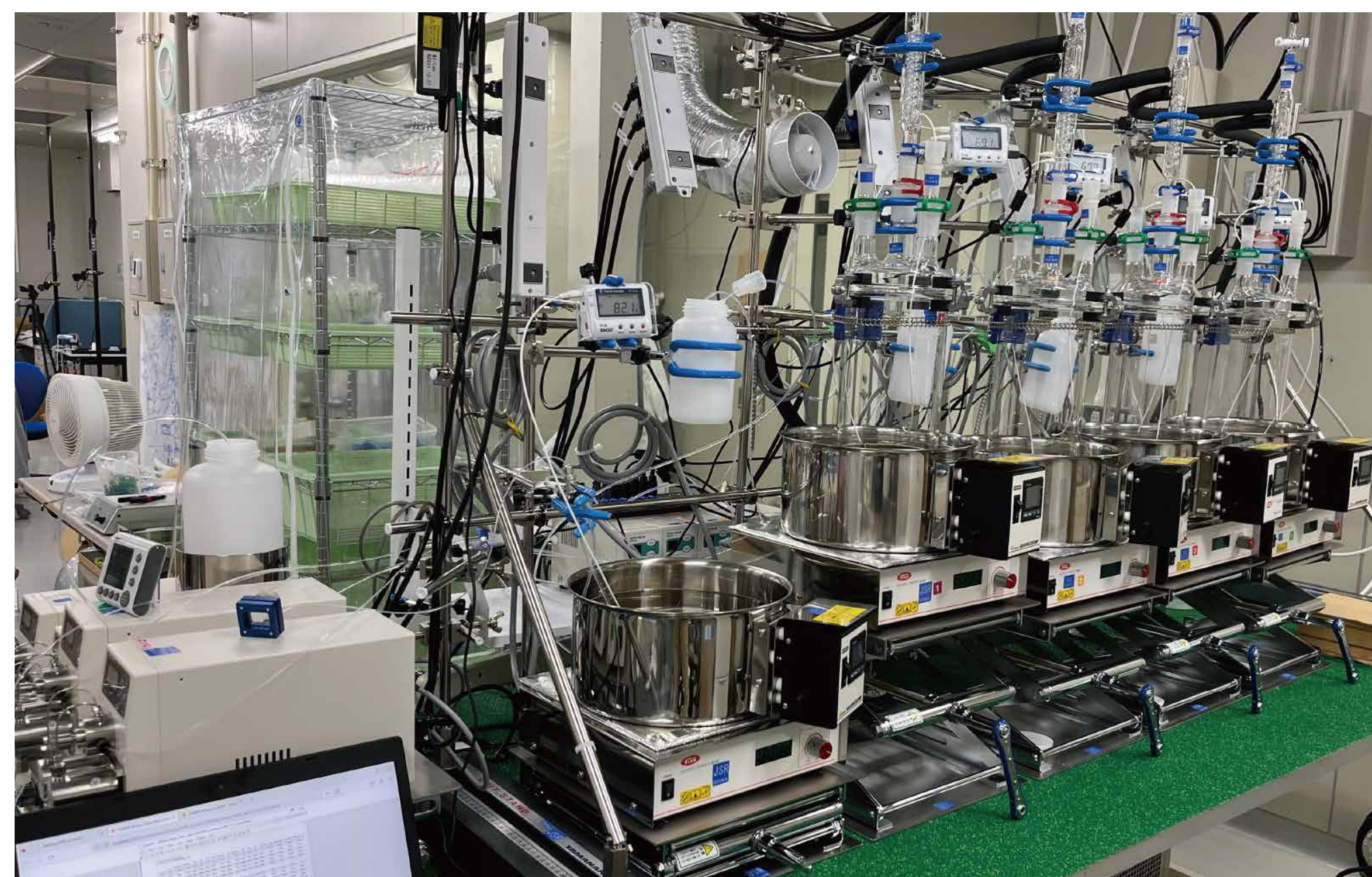
フロー・バッチ合成装置 flow-batch synthesis
