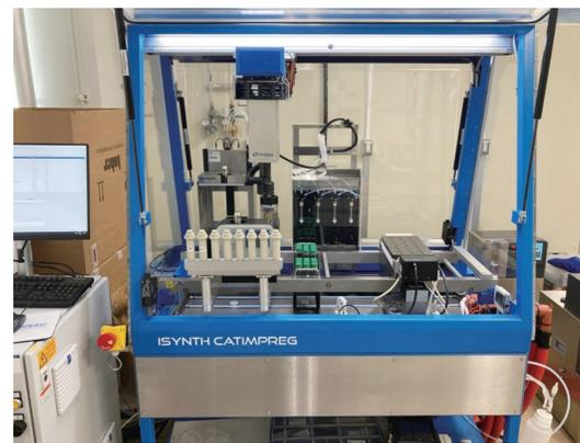
図2. 自動触媒調製装置
