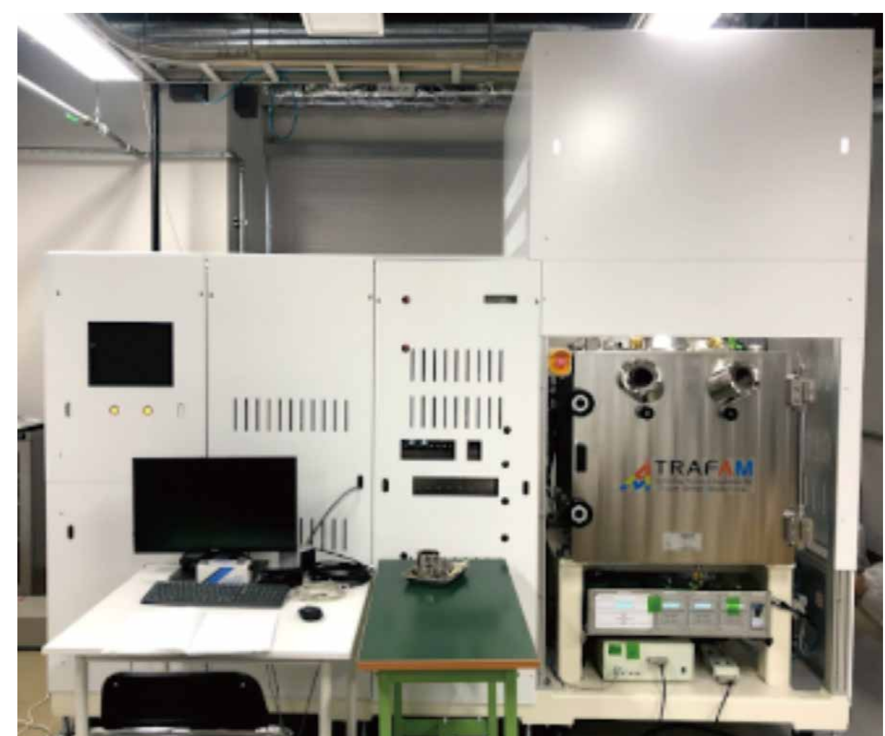
モニタリング装置(電子ビーム方式) Monitoring device(EB-PBF)
