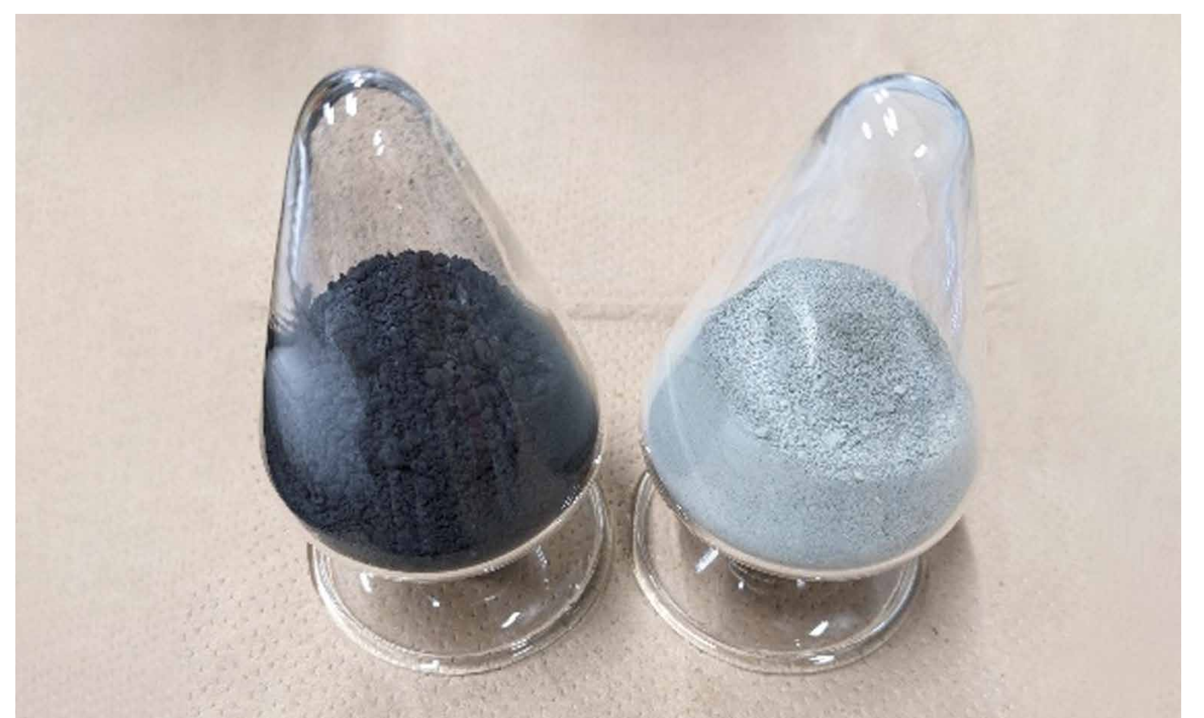
原料(左)と、合成したSiCの写真 Photo of Si sludge and synthesized SiC
