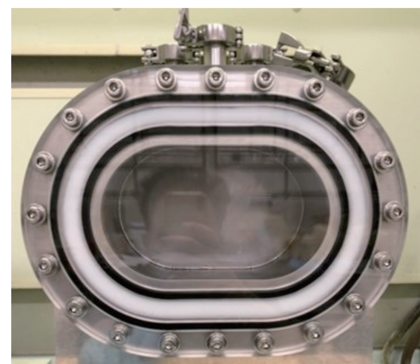
TIISA®で保冷強化した液化水素貯蔵容器 TIISA®-Enhanced Cryogenic Hydrogen Storage
