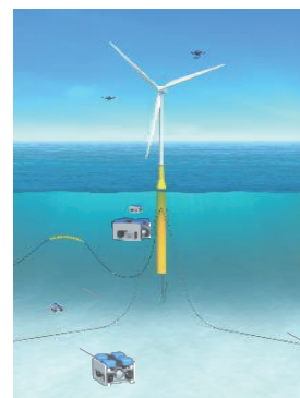
▲遠隔化・自動化による運転保守高度化
