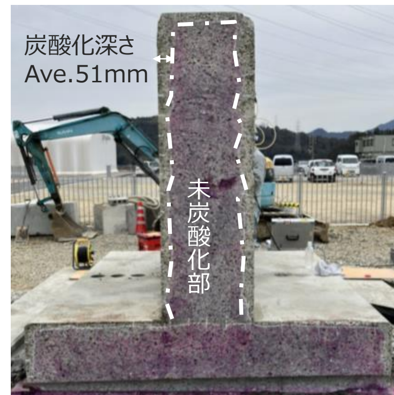
<切断面の炭酸化範囲>
