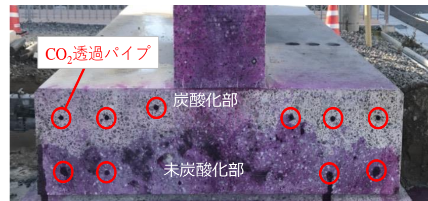
<切断面の炭酸化範囲>
