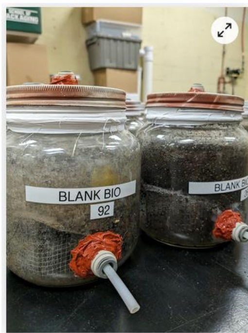
MSU の Auras 研究室が生分解実験を行うために作製したバイオリアクターの拡大写真。バイオリアクターは基本的に大きなガラス製の容器で、堆肥化中に発生するガスを測定するためのチューブが付いている。
