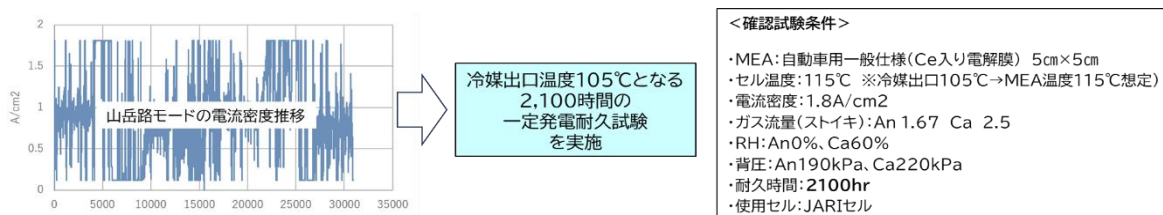
図 2.5.5-7 電解質膜劣化試験の考え方と試験条件
