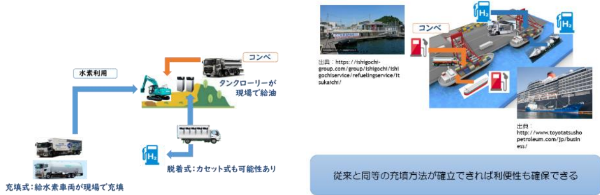
図 2.1.8-1 建機の給油・水素充填のイメージ
