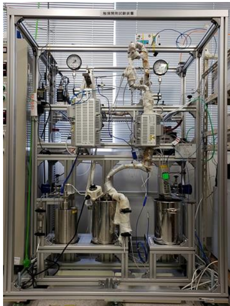
図7：ラボレベルのHiJET技術水素化装置 4
