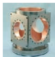
ミニマルシングルターゲットスパッタ 超高真空対応BeCuチェンバ開発と 生産効率向上 (膜厚ばらつき \leq 10\% 、背圧 < 1 \times 10^{-5}\text{Pa} )
