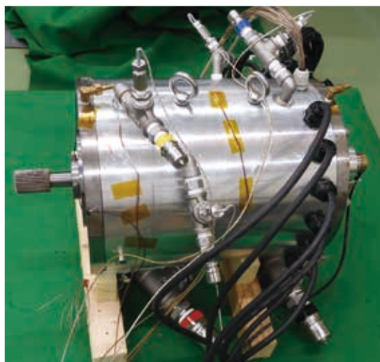
図3 効率レベルIE5 PMモーター (55kW、20000r/min)
