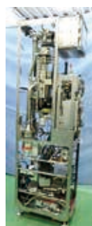
ミニマルシングルターゲットスパッタ 超高真空対応BeCuチェンバ開発と 生産効率向上 (膜厚ばらつき \leq 10\% 、背圧 < 1 \times 10^{-5}\text{Pa} )
