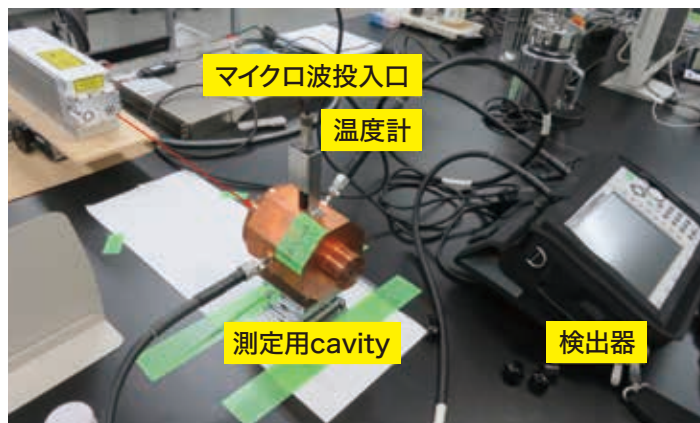
新規高温マイクロ波吸収能測定設備
