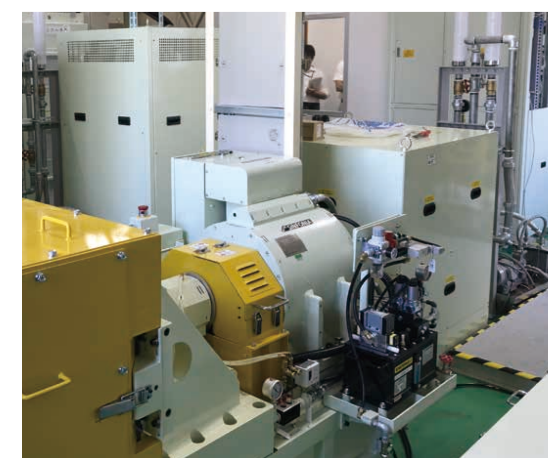
図2 導入試験設備 (仕様:25,000r/min、150kW 油冷温調装置:約25°C~100°C)
