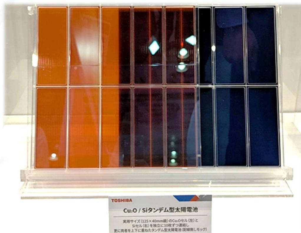
Cu<sub>2</sub>OモジュールとSiモジュールを重ねたタンデムの配線なしモック
