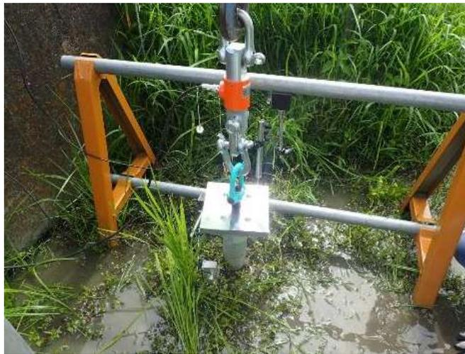
引抜き載荷試験
