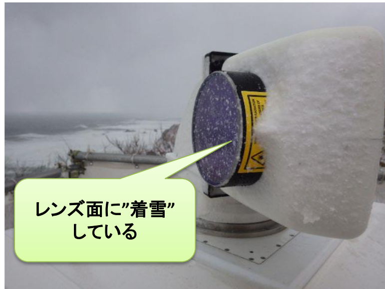
図 降雪時におけるSLレンズ面への着雪 (上ノ国地点 2022年12月15日)
