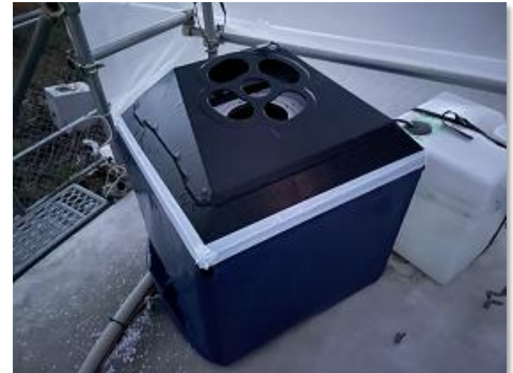
図 ウィンターキット装着例 (北海道檜山沖海域 八雲地点)
