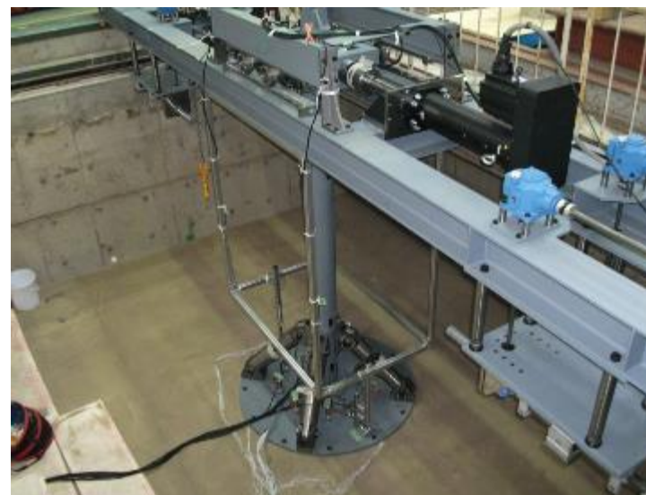
モノタイプを対象とした土槽実験
