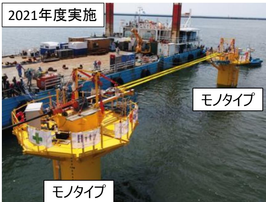
モノタイプに対する水平載荷試験
