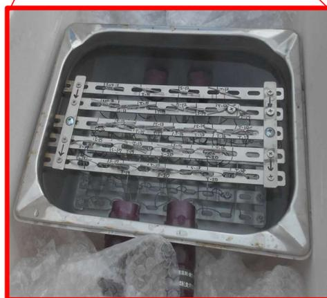
配管から一部熱水を取り出し、テストピースを浸漬させている様子
