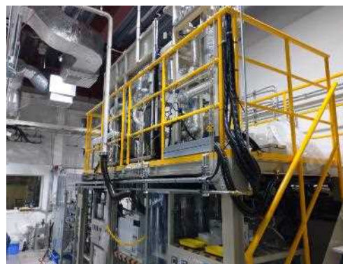
NTA大型反応器@産総研福島 触媒充填量: 100 cc 熱電対 5箇所組み込み 熱マネ評価も可能
