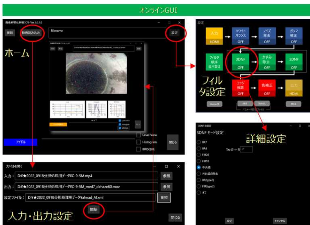
図 7.2-3 画像鮮明化処理システム オンライン用ソフトウェアの GUI
